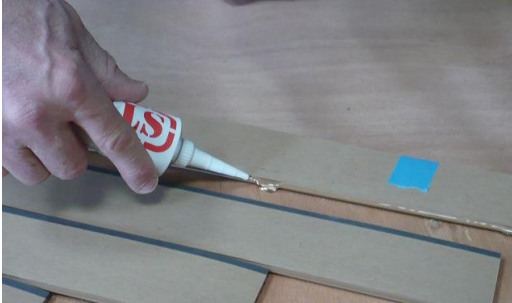
Application de la colle Stelmax
