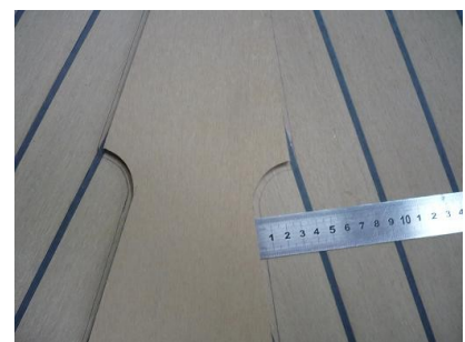
Traçage des panneaux en décalant de 5mm pour le joint
